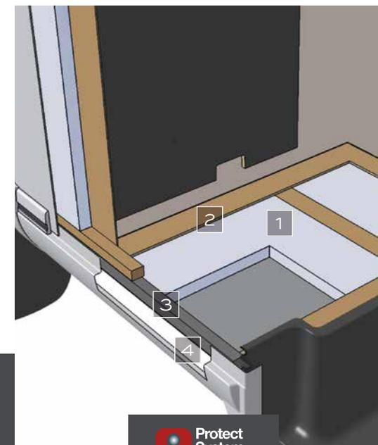
L'isolant XPS Styrofoam (30 mm de Styrofoam pour chaque côté et le plancher) possède des propriétés de haute isolation thermique, phonique, de résistance à l'eau et de légèreté reconnues.
